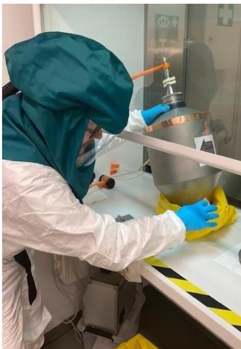
Un fusto contenente polvere di grafene viene svuotato e pulito in una cappa aspirante. Il lavoratore utilizza una protezione del filtro (TH3P) con un ventilatore e un cappuccio, indumenti protettivi di tipo 5 e guanti in nitrile.
