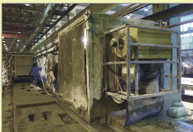
Kuva 1. Ontelolaatan sahaus. Saha on koteloitu ja varustettu kohdepoistolla.
