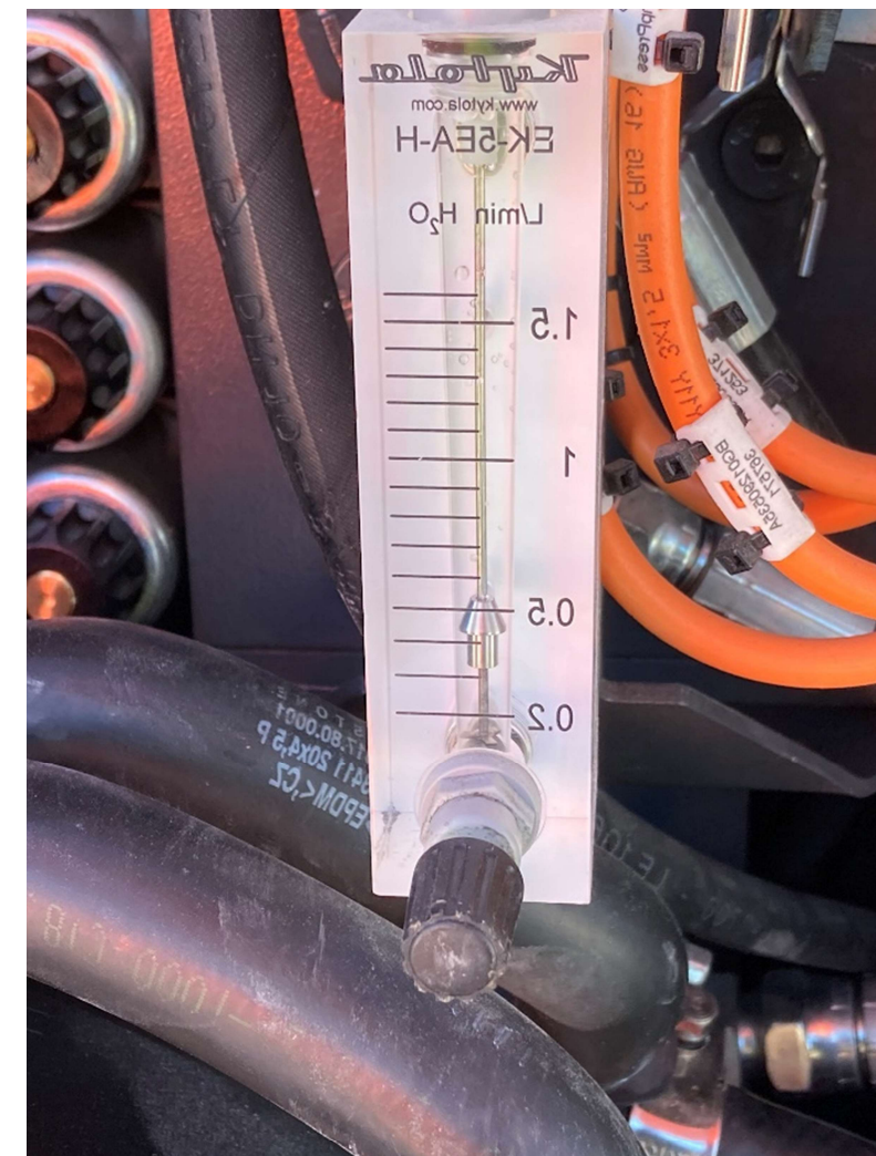
Vesisyöttö märkäporauksessa 0,4 l/min, säilön koko 40 l
