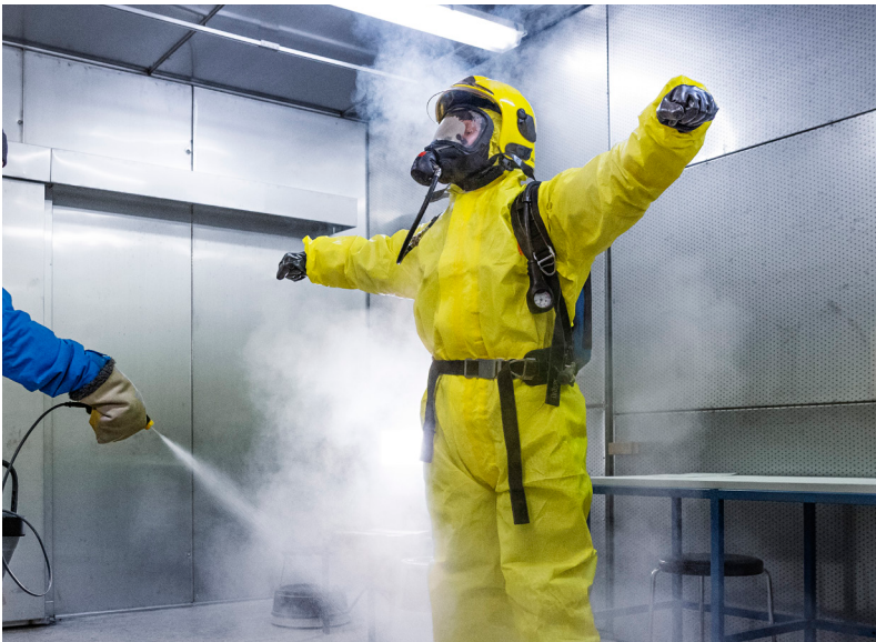
Kuva 1. Pelastajat kastuvat kemikaalionnettomuustilanteissa kemikaalien hallintaan käytetävälle vesisumutukselle. Testitilanteessa pelastaja vesisumutettiin kylmässä (-20 °C).
